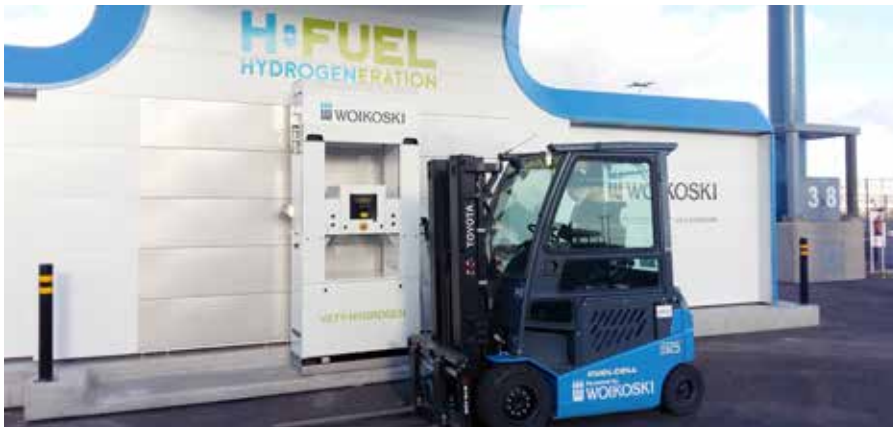
Das Kompaktmodell Traigo 80 beim Tanken von Wasserstoff bei Woikoski, Finnland.
